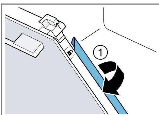
8. Extraer el primer y segundo cristal intermedio tirando de ellos hacia arriba en posición inclinada y depositarlos con cuidado sobre una superficie plana.
