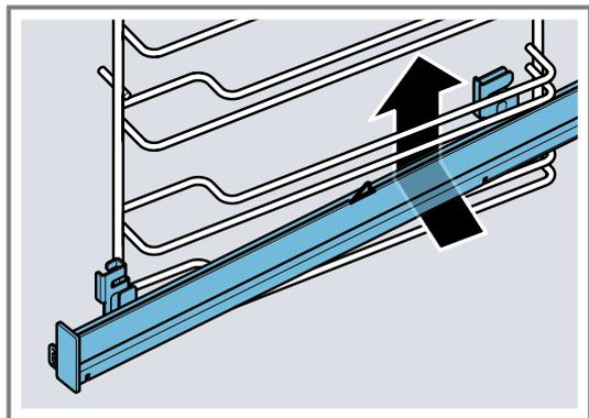
2. Guiar el riel a lo largo de las varillas de guía hacia atrás y deslizar las dos sujeciones en la varilla inferior. Al hacerlo, agarrar la varilla vertical con la sujeción trasera
