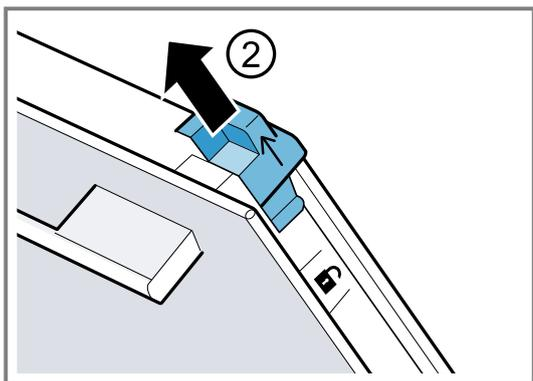
6. Extraer el cristal interior tirando de él hacia arriba en posición inclinada y depositarlo con cuidado sobre una superficie plana.
