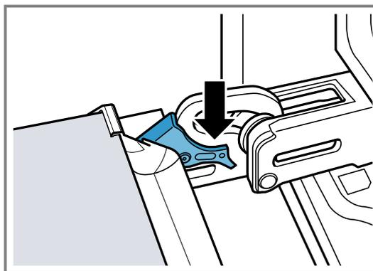
✓ Las palancas de retención están cerradas. La puerta del aparato está asegurada y no puede desengancharse.
