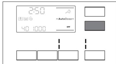
5. Para establecer la dosis básica, toque los botones del depósito hasta que aparezca la dosis predeterminada del producto de lavado y dos flechas en la parte
