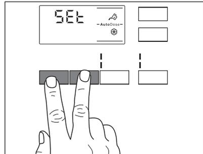
4. Toque los botones del depósito relacionados para activar y desactivar la función. La pantalla muestra OFF cuando un depósito está desactivado o muestra un indicador cuando está activado.
