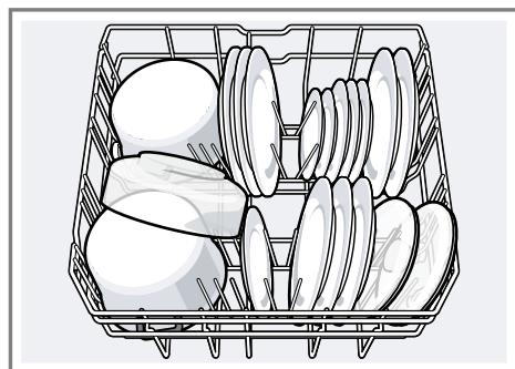
Los platos grandes hasta un diámetro de 31 cm se pueden colocar en el cesto inferior tal como se muestra en la ilustración.
