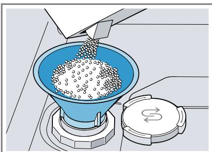
Llenar el depósito completamente con sal especial. De este modo, se desplaza y evacua el agua contenida en el depósito.
